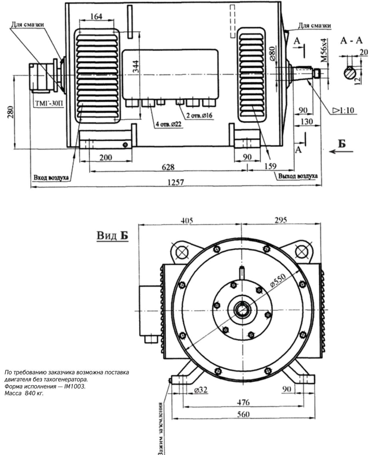
По требованию заказчика возможна поставка двигателя без тахогенератора. Форма исполнения — IM1003. Масса 840 кг.
