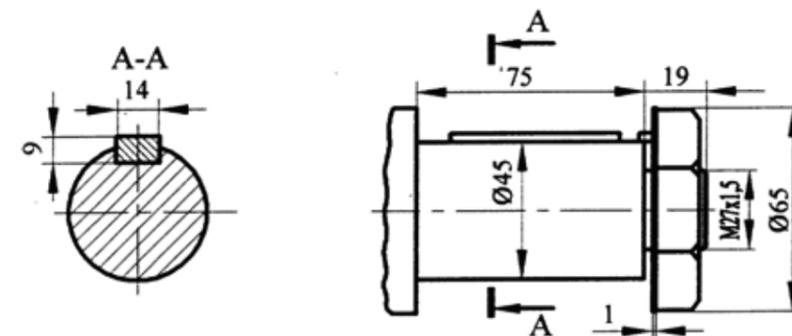
РИС. 5.3.3 ГАБАРИТНЫЕ И УСТАНОВОЧНО-ПРИСОЕДИНИТЕЛЬНЫЕ РАЗМЕРЫ ДВИГАТЕЛЕЙ КР2732А МАССА 310 КГ.
