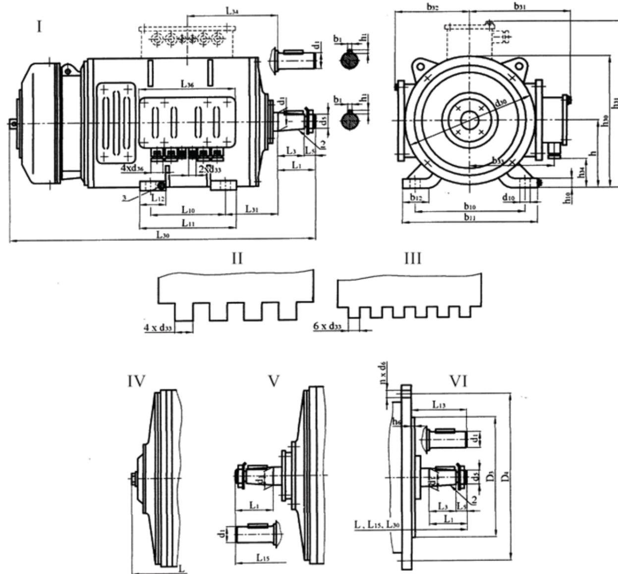
I — исполнение с тормозом; IV — исполнение с одним концом вала; V — исполнение с двумя концами вала; VI — исполнение с фланцами;
