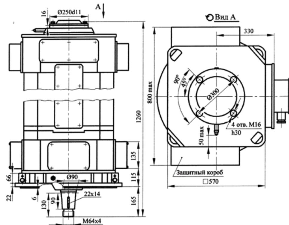
ТАБЛИЦА 8.4.1 ТЕХНИЧЕСКИЕ ДАННЫЕ БУРОВЫХ ДВИГАТЕЛЕЙ Д908Б, ДВ908Б
