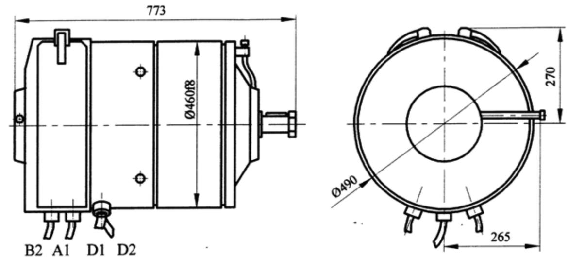
РИС. 5.3.2 РАЗМЕРЫ УНИФИЦИРОВАННЫХ КОНЦОВ ВАЛА ДВИГАТЕЛЕЙ КР2732 И КР2732А
