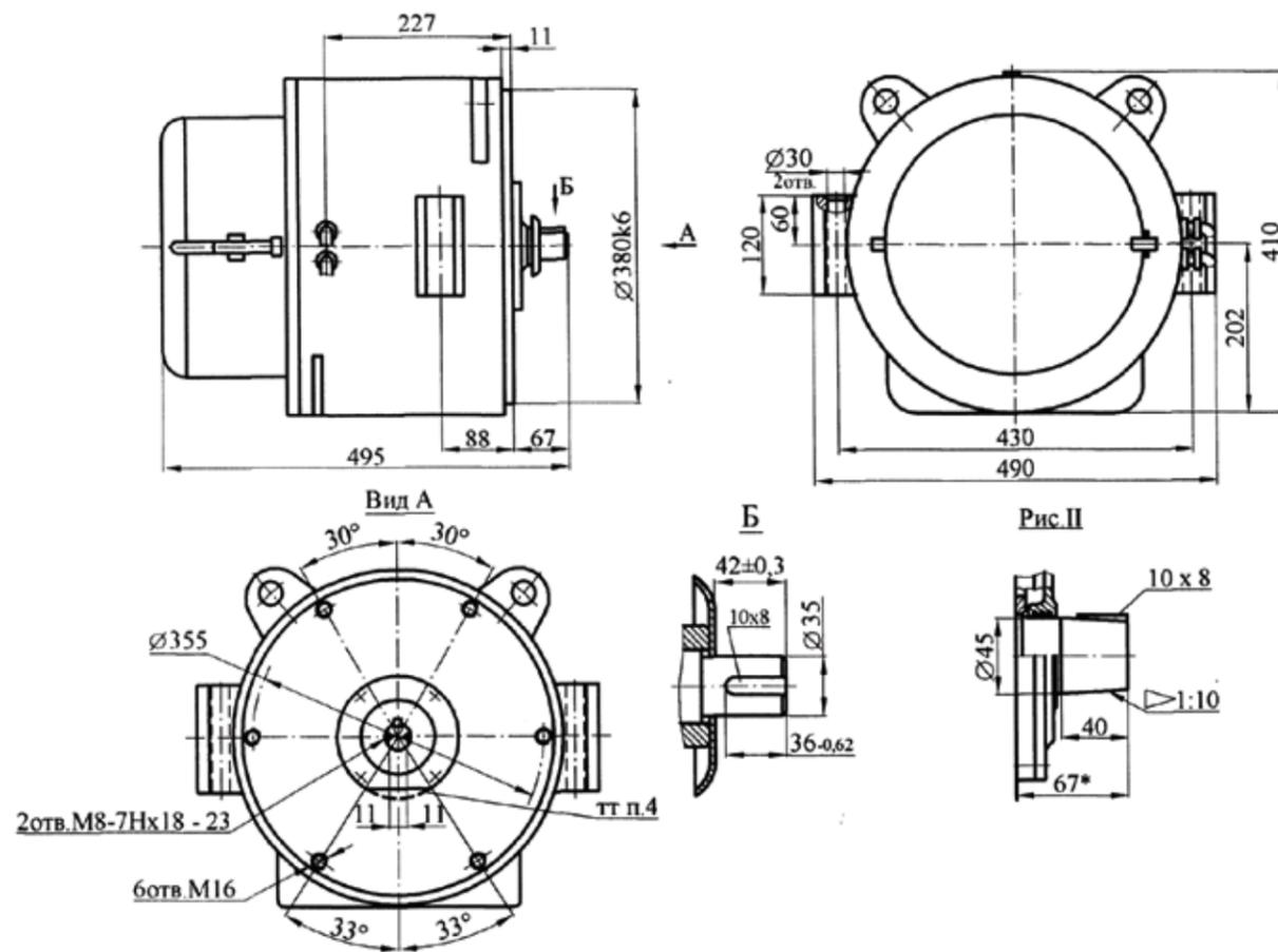
Двигатель предназначен для вентилятора и низковольтного генератора троллейбусов и трамваев.
