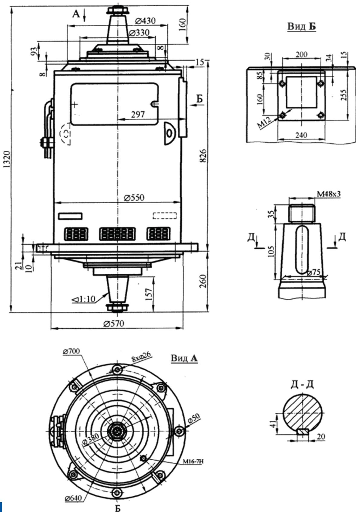
РИС. 2.1.2 ГАБАРИТНЫЕ И УСТАНОВОЧНО-ПРИСОЕДИНИТЕЛЬНЫЕ РАЗМЕРЫ ДВИГАТЕЛЕЙ ДПЭ12. ФОРМА ИСПОЛНЕНИЯ IM1001. МАССА — 125 КГ
