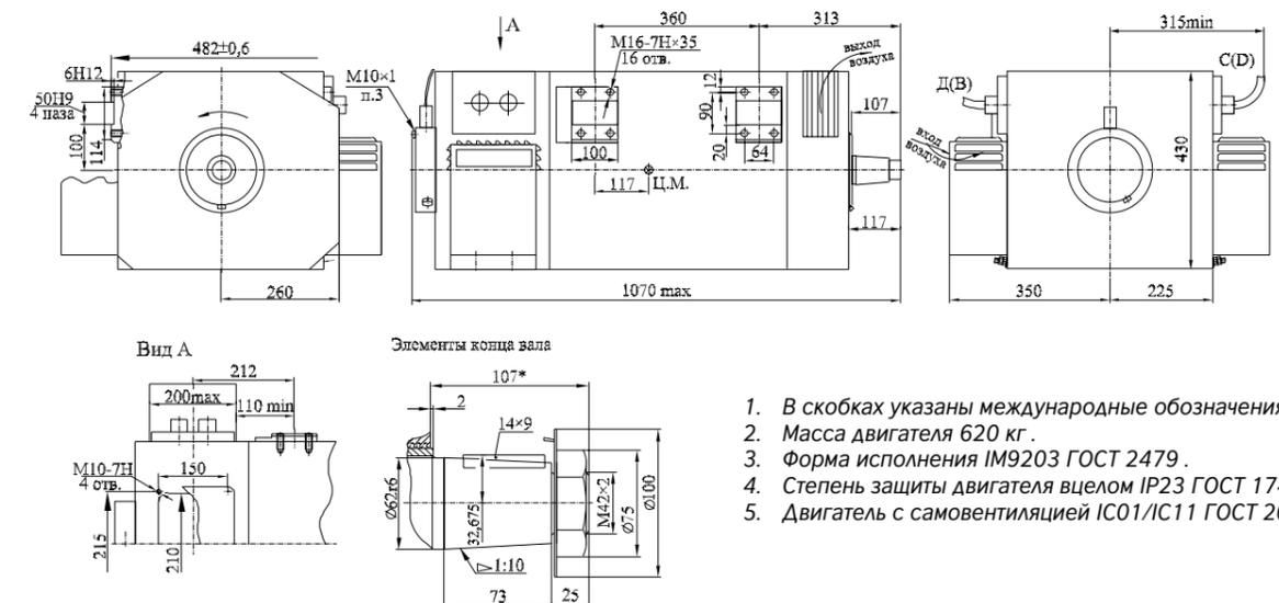
Генератор предназначен для путеукладочных кранов УК-25/20 и других самоходных железнодорожных машин, а также для стационарных механизмов различного назначения.
