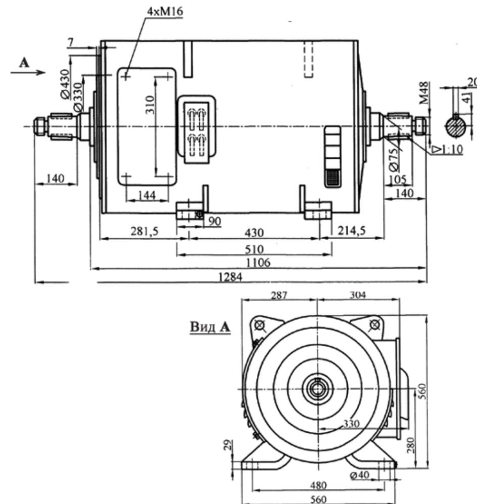
Экскаваторные двигатели ДЭ(В)808 разработаны на базе краново-металлургических двигателей Д808 (см. раздел 1.1). По сравнению с двигателями типа ДПЭ(В)52 (см. раздел 2.1) двигатели ДЭ(В)808 имеют следующие отличительные признаки:
