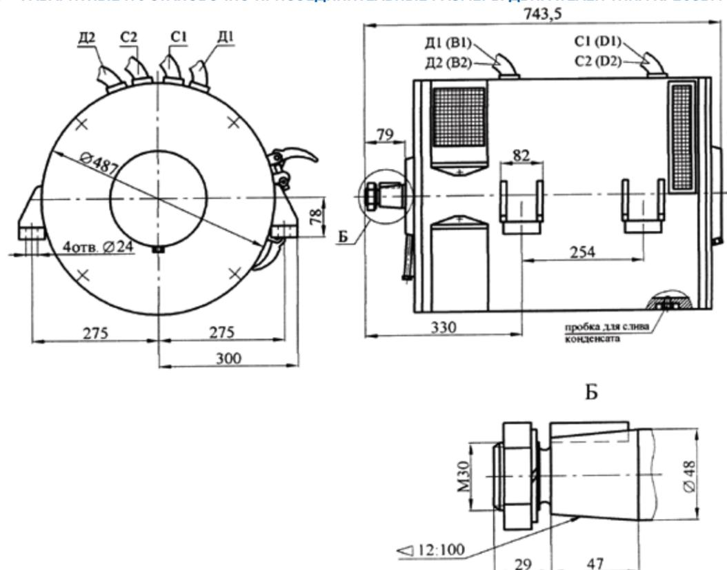
РИС. 4.3.1 ГАБАРИТНЫЕ И УСТАНОВОЧНО-ПРИСОЕДИНИТЕЛЬНЫЕ РАЗМЕРЫ ДВИГАТЕЛЕЙ КР309А
