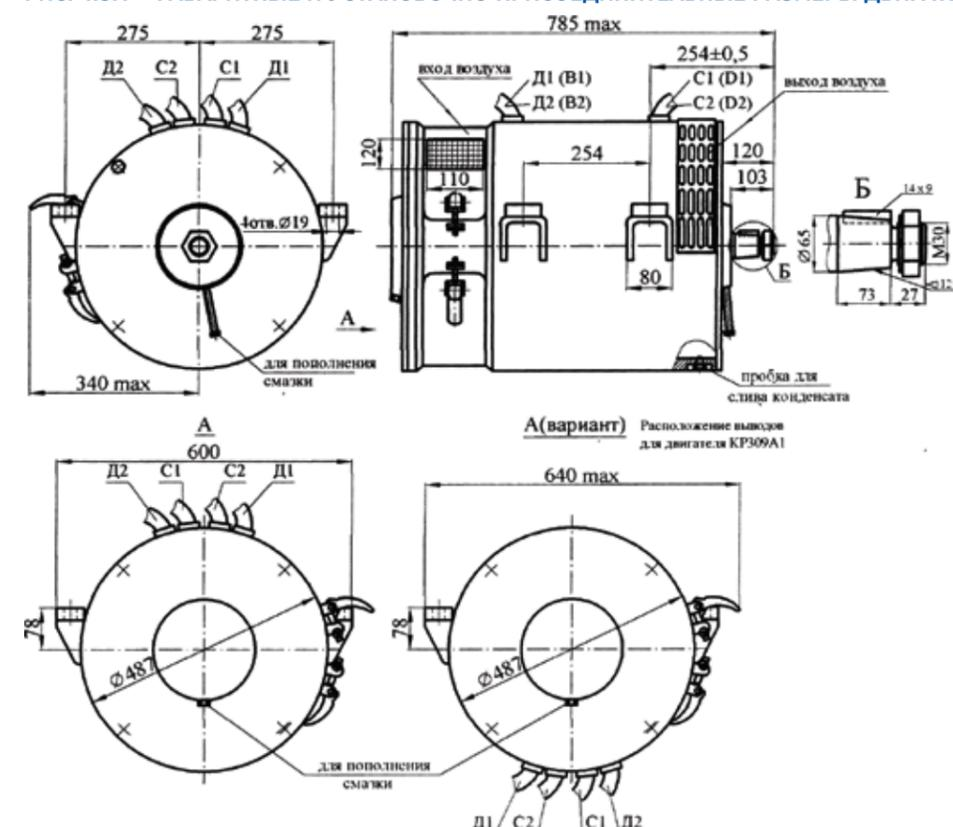
Генератор предназначен для работы на путеукладочных кранах УК-25/20 и других самоходных железнодорожных машинах.
