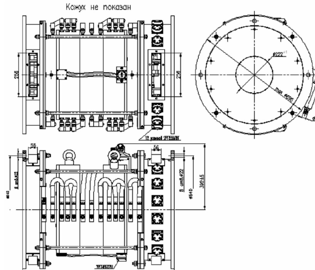
**Высокооборотные синхронные генераторы в индукторном исполнении для систем электропитания мощностью 300 Вт (СЭП -03КМ) и 10 кВт (СЭП -10КМ)**
