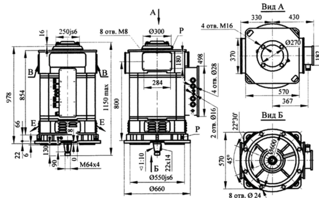
РИС. 8.4.2 ГАБАРИТНЫЕ И УСТАНОВОЧНО-ПРИСОЕДИНИТЕЛЬНЫЕ РАЗМЕРЫ ДВИГАТЕЛЕЙ ДВ908Б.
