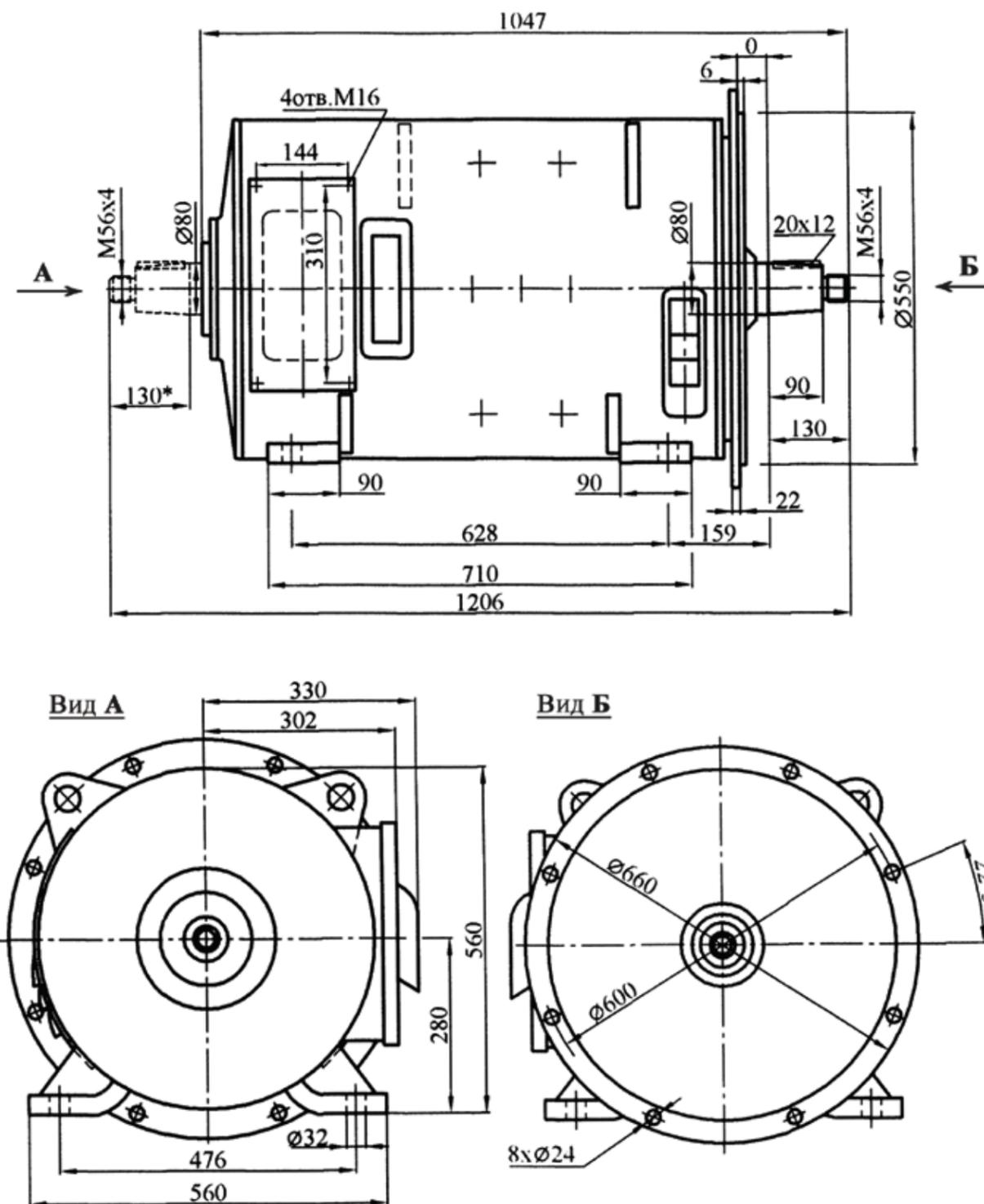
ТАБЛИЦА 2.2.1 ДВИГАТЕЛИ ТИПА ДЭ(В) ДЛЯ ЭКСКАВАТОРОВ (НЕЗАВИСИМОЕ ВОЗБУЖДЕНИЕ)
