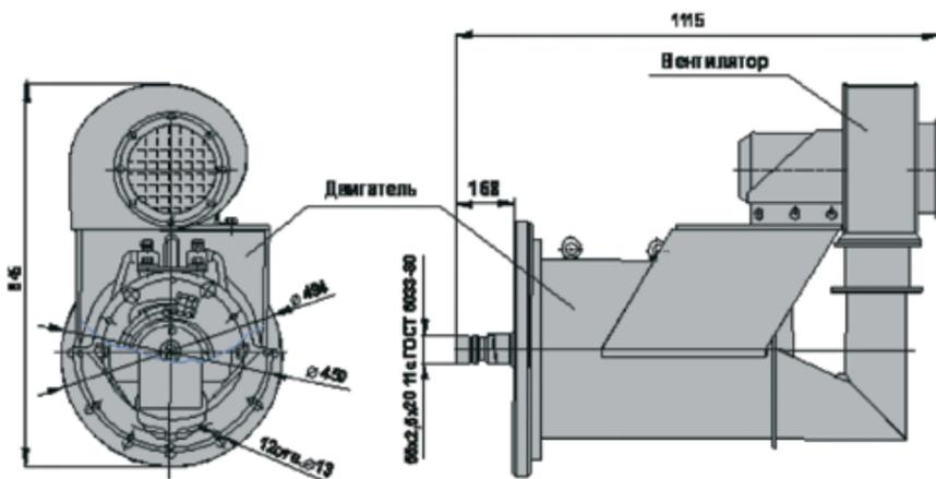
Система электрического запуска газотурбинных двигателей типа НК-16 СТ, НК-16-18СТ и их аналогов 16.907.000 СЭЗ ТУ
