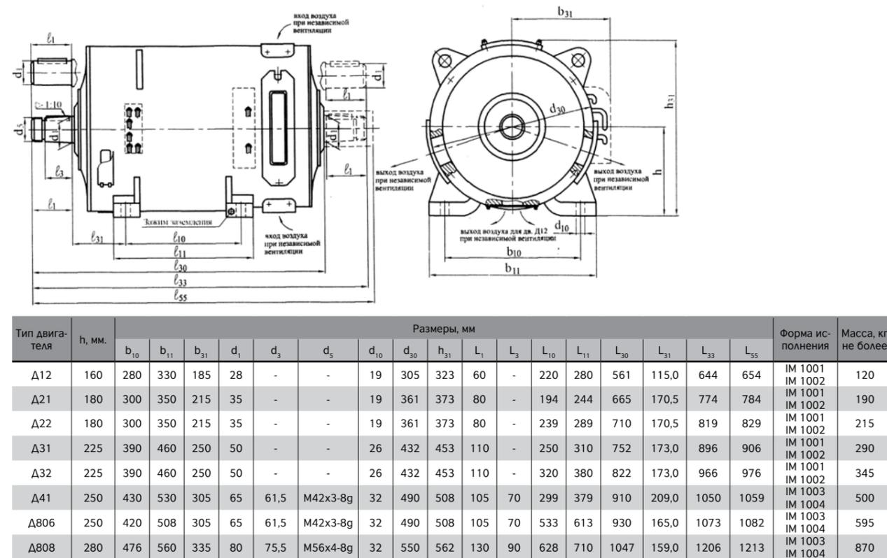
РИС. 1.1.3 ГАБАРИТНЫЕ И УСТАНОВОЧНО-ПРИСОЕДИНИТЕЛЬНЫЕ РАЗМЕРЫ И МАССА ГОРИЗОНТАЛЬНО ФЛАНЦЕВЫХ НА ЛАПАХ ДВИГАТЕЛЕЙ Д12 - Д808. ФОРМЫ ИСПОЛНЕНИЯ IM2001, IM2002, IM2003, IM2004
