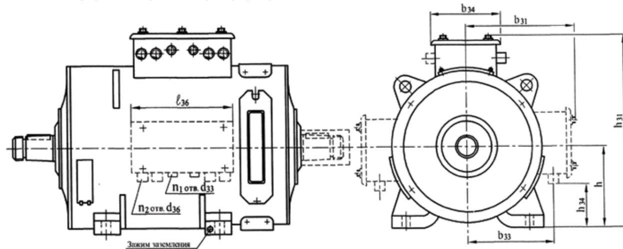
1. Форму и размеры конца вала, а также габаритные, установочные, присоединительные размеры двигателей см. рис. 1.1.2, на котором масса двигателей указана без коробки.
