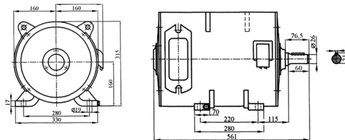
РИС. 2.1.3 ГАБАРИТНЫЕ И УСТАНОВОЧНО-ПРИСОЕДИНИТЕЛЬНЫЕ РАЗМЕРЫ ДВИГАТЕЛЕЙ ДПЭ52. ФОРМА ИСПОЛНЕНИЯ IM1004. МАССА — 860 КГ
