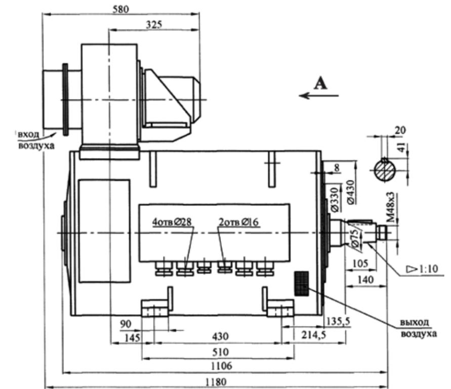
РИС. 2.3.2 ГАБАРИТНЫЕ И УСТАНОВОЧНО-ПРИСОЕДИНИТЕЛЬНЫЕ РАЗМЕРЫ ДВИГАТЕЛЕЙ КРЭ75, КРЭ80
